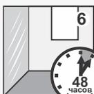
**6** Работы следует проводить при температуре воздуха и основания от +15 до +30°C и относительной влажности воздуха не более 75%, при условии, что температура массы клея не ниже +10°C. Рекомендуемая влажность основания не более 10%.
